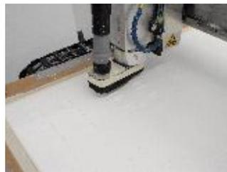
Damit die ausgefrästen Teile nicht herausfallen und den Fräskopf beschädigen, werden sie durch kleine Stege im Plattenmaterial gehalten. Als Ergebnis erhält man ein Gitter mit darin enthaltenen Frästeilen. Diese werden von Hand ausgebrochen oder mit einem Cuttermesser abgetrennt. Ausserdem erfolgt eine grobe Reinigung von Frässpänen, soweit aufgrund der statischen Materialaufladung möglich. Meist befindet sich noch Schutzfolie einseitig auf dem Material.
